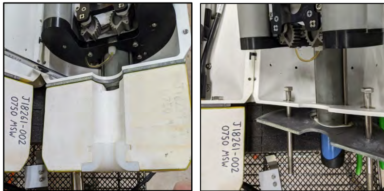
Figure 2-2: Remove Aanderaa optode bottom float
