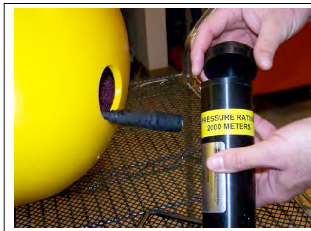
Figure 9-19: Placing the Cap on the PAR
